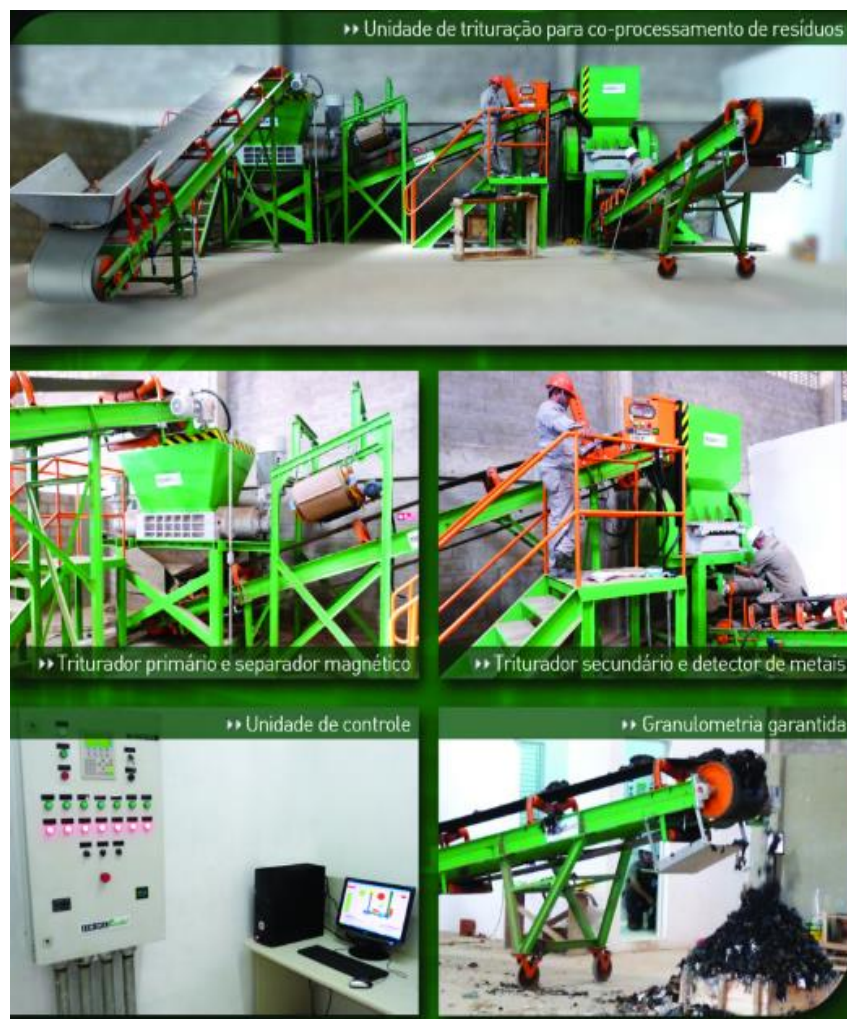
Figura 10 - Sistema de trituração automatizado
