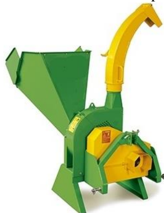
Figura 8 – Máquina de triturar madeira acoplada na TDP do trator
