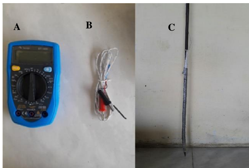
Figura 18 – Multímetro digital (A), Termopar (B) e Haste de ferro (C) utilizados para aferir a temperatura no solo
