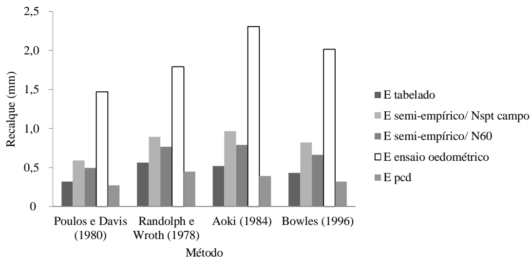
Figura 4.17: Comparação das estimativas dos recalques das estacas isoladas para uma carga de 17,2kN ( Q_{25\%} )
