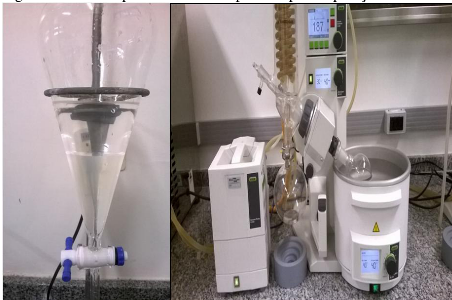
Figura 4 - Balão separador e rota evaporador para separação dos metabólitos
