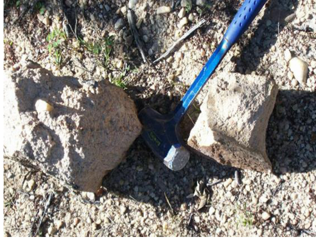
Figura 31: Aspecto macroscópico da rocha, apresentando grânulos de quartzo e feldspato potássico
