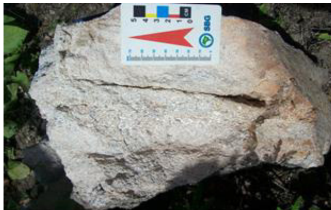
Figura 16 - Aspecto macroscópico da rocha, com grânulos de quartzo e feldspato potássico
