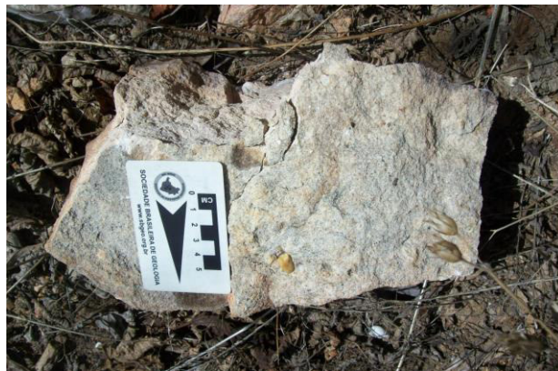
Figura 14 - Aspecto macroscópico da rocha, com presença de grânulos de feldspato potássico e matriz arcoseana.
