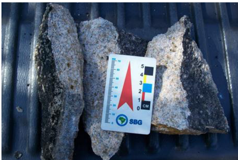
Figura 28 -Aspecto macroscópico da rocha, presença de grânulos de quartzo e feldspatos
