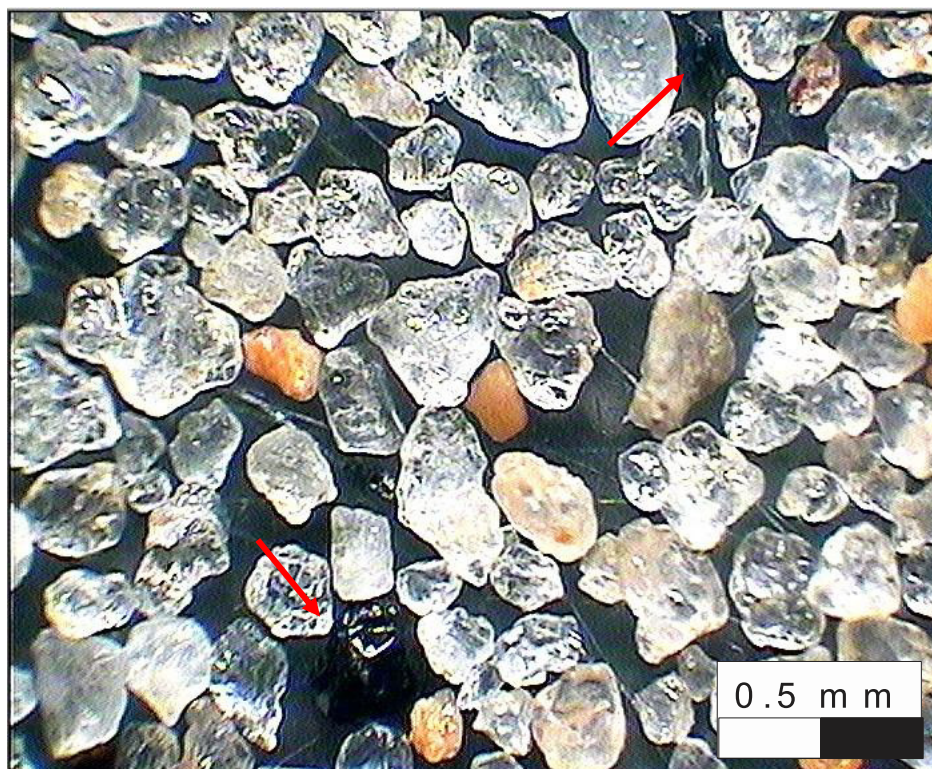
Figura 99 – Minerais pesados entre os grãos de quartzo, Detalhe da figura 58.
