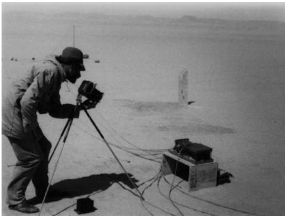
Figura 4 – Estudos de vento usando um manômetro múltiplo em tempestade de areia perto de Gilf Kebir, Líbia em 1938. Fotografia de Ronald Peel (Underwood, Jr., 1999).
