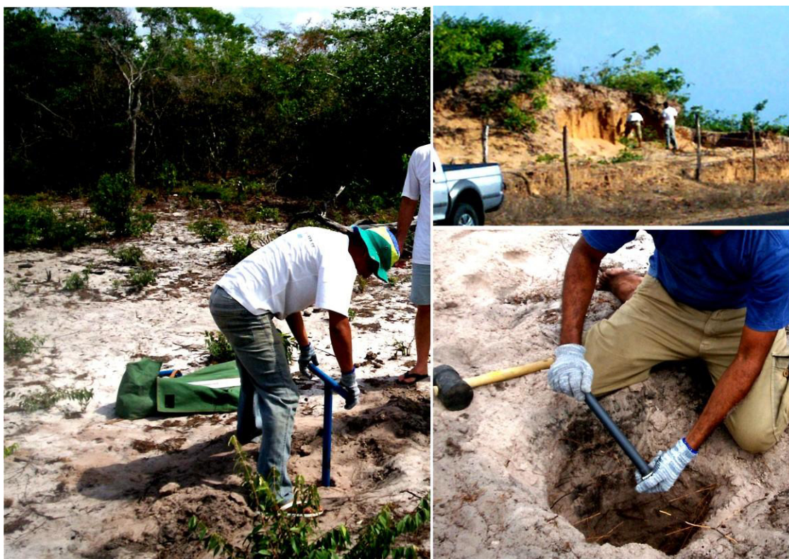
Figura 24 – Coleta de sedimento com uso de trado manual e canos de PVC.
