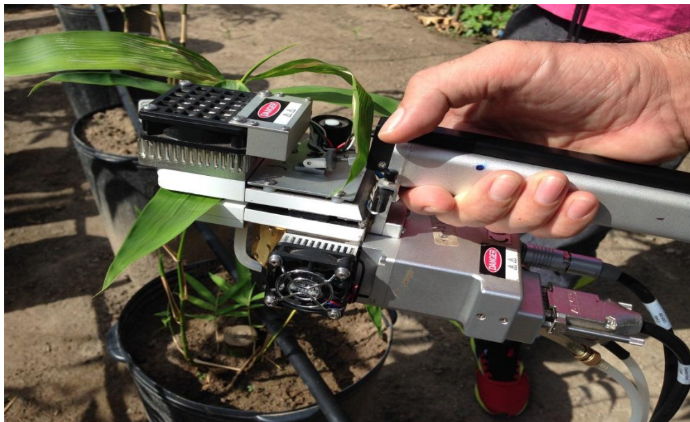
Figura 8 – Avaliação das trocas gasosas em folhas de bambu com o IRGA
