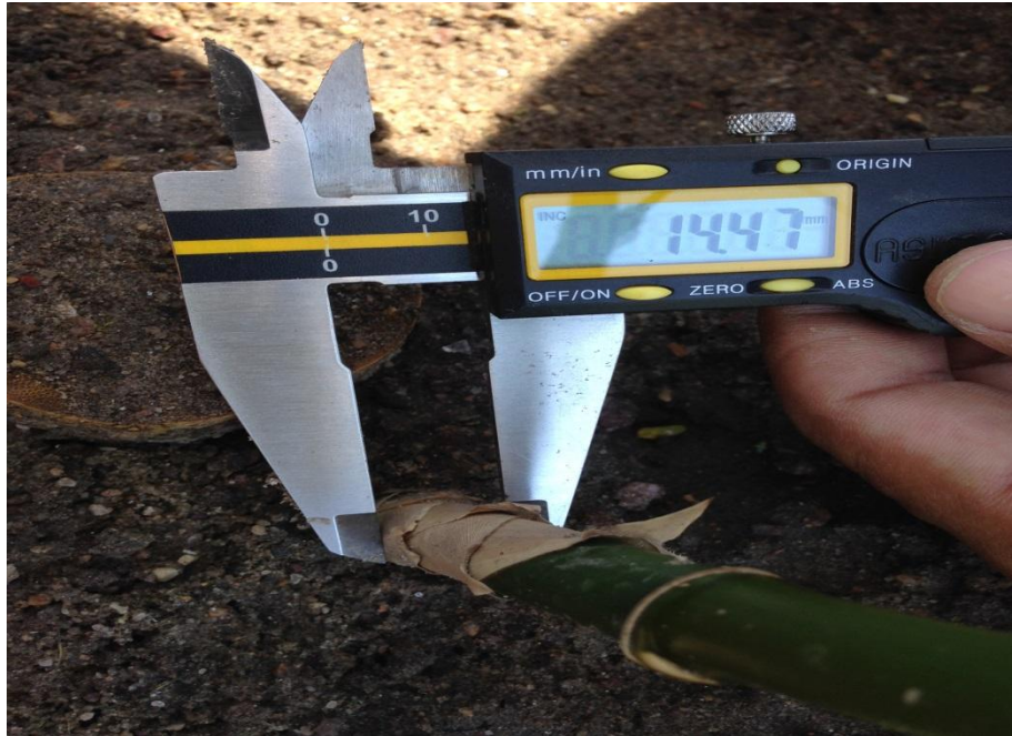
Figura 6 – Coleta de dados de diâmetro do caule (DC) utilizando-se paquímetro digital
