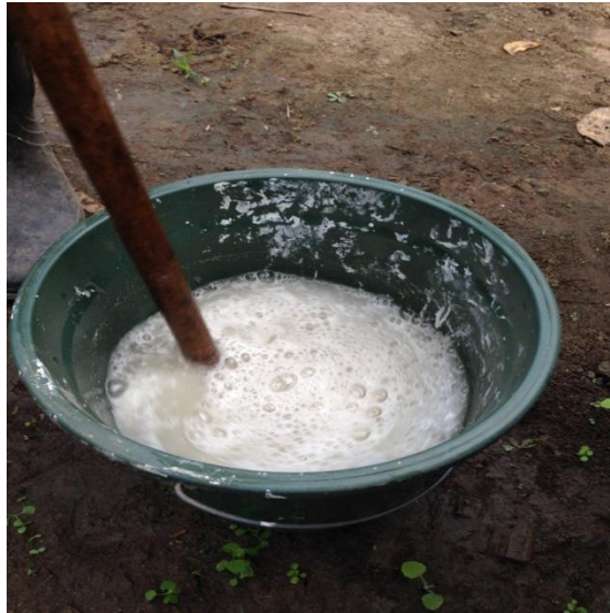
Figura 5 – Diluição dos sais NaCl e CaCl 2 .2H 2 O para obtenção do nível salino desejado
