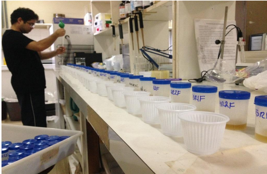
Figura 10 – Amostras dos órgãos vegetais sendo diluídas em água deionizada
