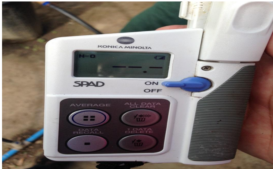
Figura 9 – Medidor portátil SPAD para obtenção do índice relativo de clorofila (IRC)
