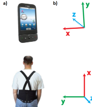
Figura 13 – a) Smartphone utilizado em (ALBERT et al. , 2012) e a localização do mesmo nas costas do indivíduo. b) Eixos do acelerômetro das figuras à esquerda.
