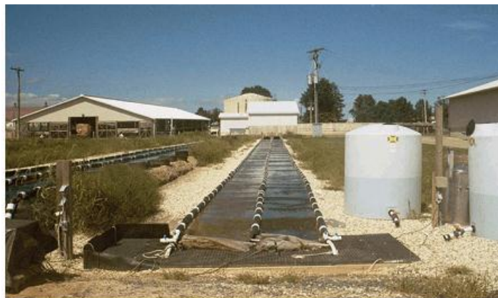
Figura 3 – Foto de cultivo feito em Turf Scrubber . Tela de fixação no final do escoamento do efluente.
