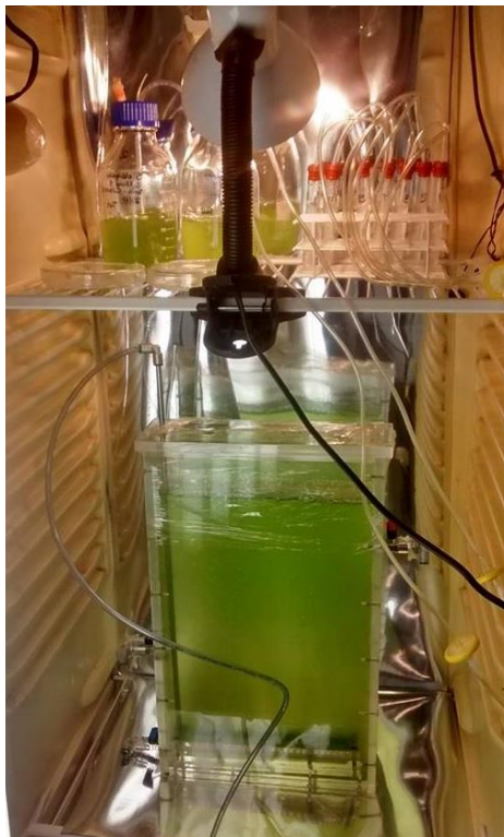
Figura 13 – Fotobiorreatores (cilíndrico e retangular) utilizados para o cultivo das microalgas.
