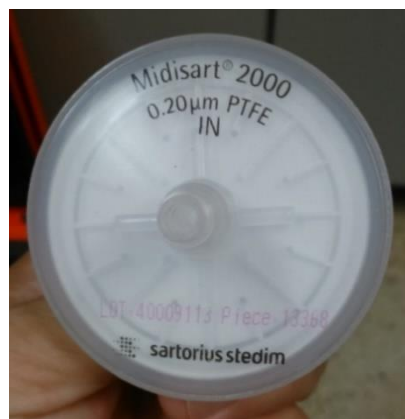
Figura 17 - Filtro de retenção de vapores oriundos do biogás de aterros sanitários Midisart.
