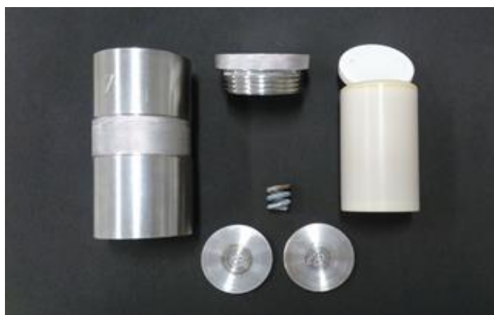
Figura 8 - Reator de síntese de zeólitas
