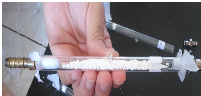
Figura 16 - Cartucho contendo amostra, sem empacotamento ainda, mensurada em peso de zeólitas 4A.
