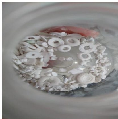
Figura 13 - Pellets de zeólitas 4A confeccionados em formato de roscas
