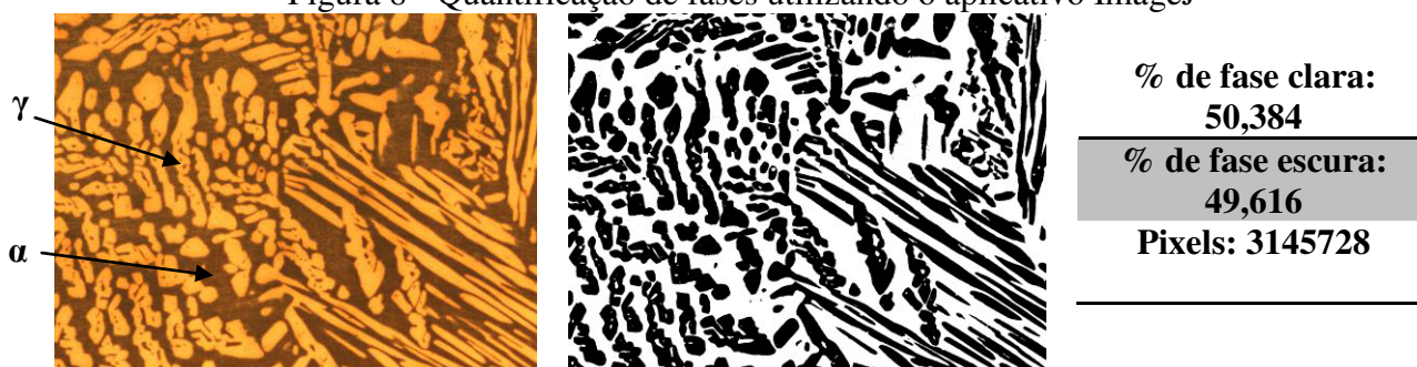
Figura 8 - Quantificação de fases utilizando o aplicativo ImageJ
