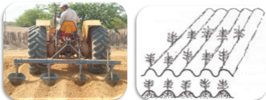
Figura 3- Captação de água da chuva in situ com sulcamento pré-semeadura. Abertura do sulco e formação do camalhão e implantação da cultura após preparo do solo
