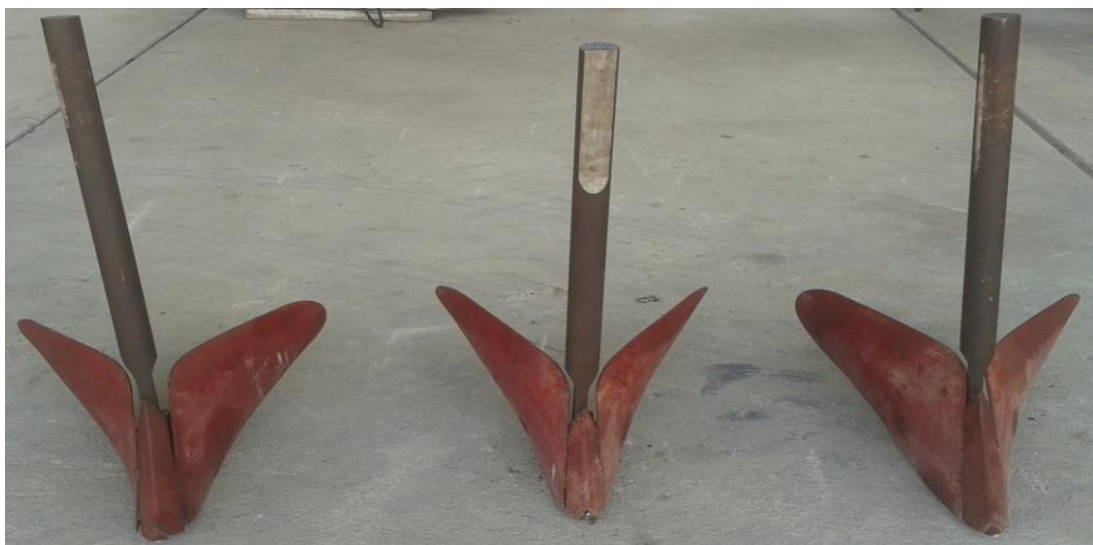
Figura 31- Peça desenvolvida ligada ao mecanismo sulcador para abertura do sulco no solo
