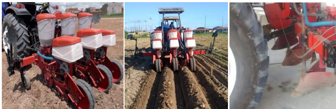
Figura 16-Semeadora-adubadora de precisão pneumática modelo JMJM2090EX.00 equipada com sulcadores para abertura do sulco e formação do camalhão
