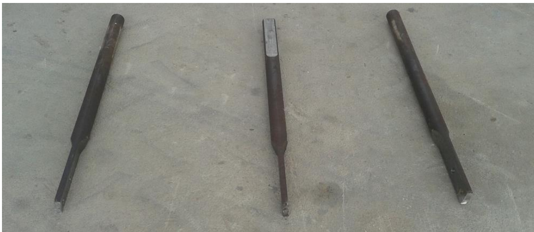
Figura 30- Peça desenvolvida para fazer a ligação do mecanismo sulcador ao chassi da semeadora-adubadora
