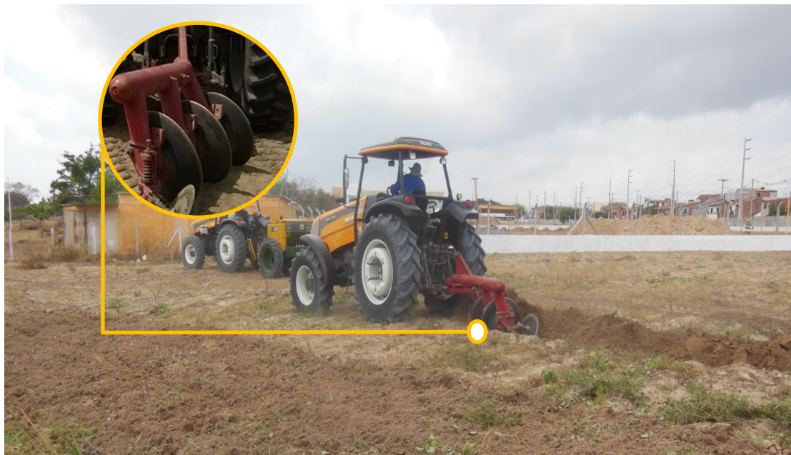
Figura 10-Arado de disco fixo montado, tricurpo com discos lisos de 0,60 m de diâmetro utilizado para o preparo da área
