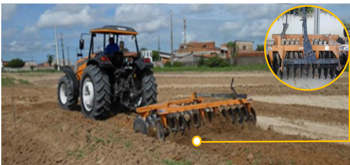
Figura 11-Grade leve de arrasto da marca Marchesan, modelo GN, OFF- Set, com 28 discos de 0,508 m de diâmetro utilizada para o preparo da área
