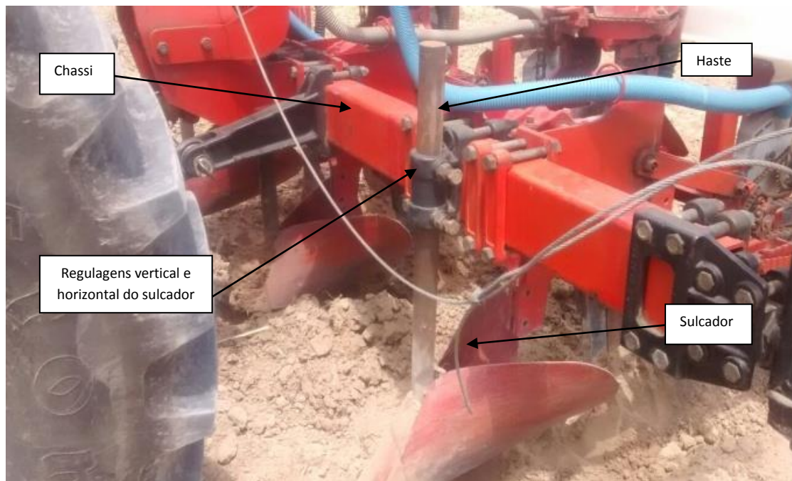
Figura 32- Mecanismo sulcado ligado ao chassi da semeadora-adubadora de precisão utilizada para semeadura do milho
