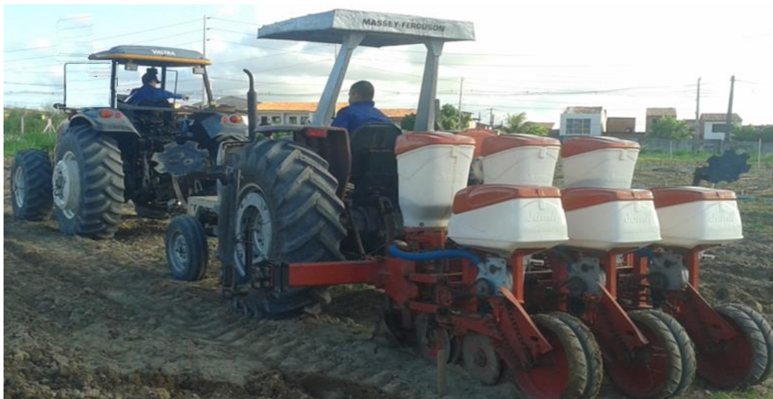
Figura 17-Trator 4 x 2 Massey Ferguson 265 usado como trator suporte no comboio para o processo de semeadura
