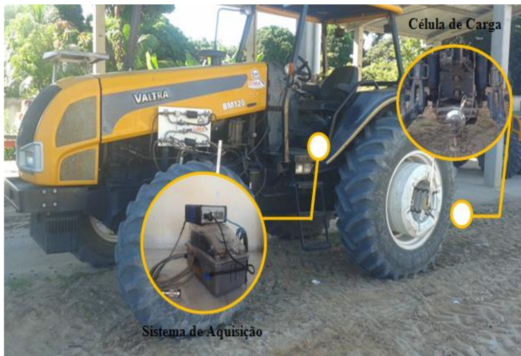
Figura 18-Célula de carga e sistema de aquisição de dados instalados no trator BM 120 4x2 TDA
