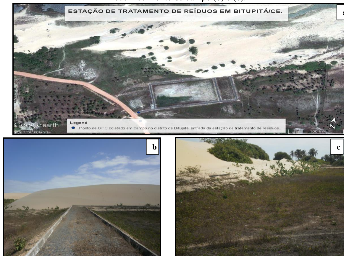
Figura 29 - Migração natural das dunas em Bitupitá invadindo a estação de tratamento de resíduos através de imagens do Google Earth Pro em 15/10/2009 com pontos coletados por GPS em campo (a) e migração das dunas em setembro de 2015 em reconhecimento de campo (b) e (c).
