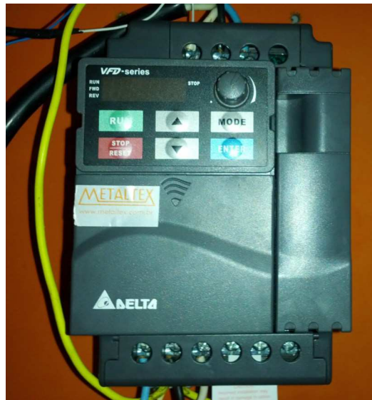
Figura 11 - Inversor de Freqüência
