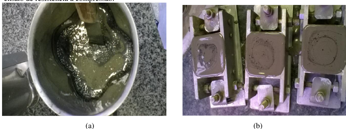
Figura 4.23 – Pastas misturadas: (a) pasta recém-misturada. (b) pastas no molde dos corpos de prova para ensaio de resistência à compressão.
