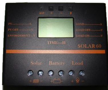
Figura 69 – Controlador de Carga
