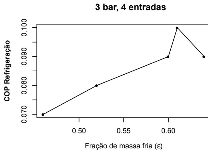
Figura 32 – Coeficiente de Performance 4 entradas, 3 bar
