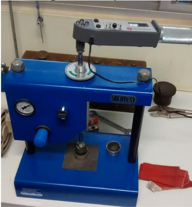
(16a) Torquímetro aclopado ao coesímetro
