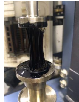
(a) Deformações em 1 ciclo de fluência e recuperação no MSCR (b) Fim do ensaio no DSR
