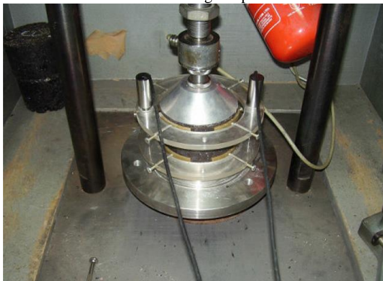
b) Ensaio uniaxial com configurações diferentes da proposta de Witczak et al. (2002)
