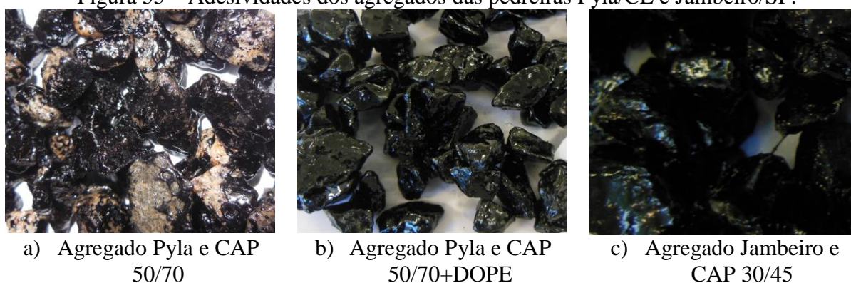
Figura 55 – Adesividades dos agregados das pedreiras Pyla/CE e Jambeiro/SP.
