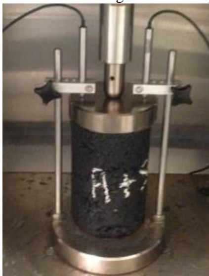
a) Ensaio uniaxial conforme Witczak et al. (2002)
