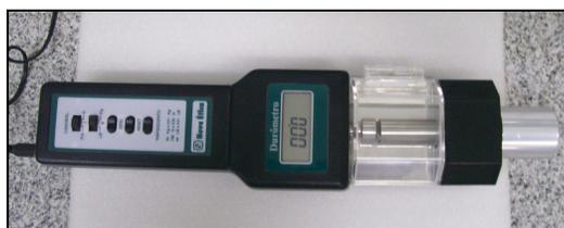
**FIGURA 7 – Durômetro utilizado na equivalência farmacêutica de comprimidos de Carbamazepina e Diazepam.**
