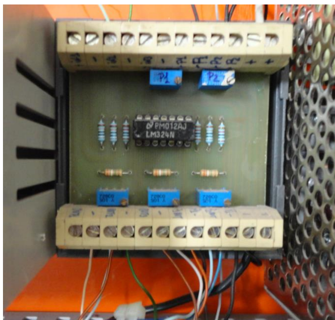
Figura 17 - Placa amplificadora do sinal.
