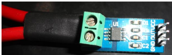
Figura 10 - Sensor de corrente ACS712 e esquemático de ligação do sensor.
