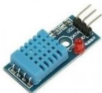
Figura 19 - Sensor DHT11 e aplicação do sensor.
