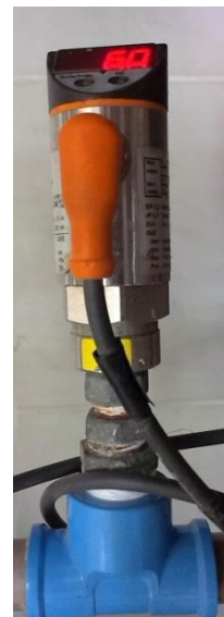
Figura 21 - Sensor de pressão combinada PN2024.
