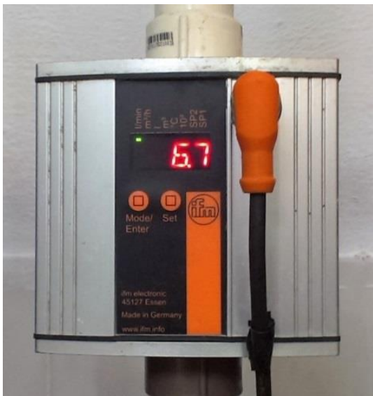
Figura 20 - Sensor de fluxo volumétrico SU7000.
