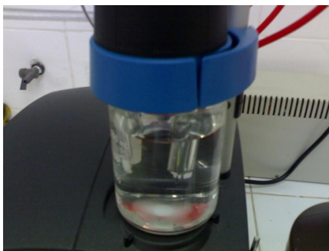
Figura 11: Coloração da amostra no ponto final de cada titulação
