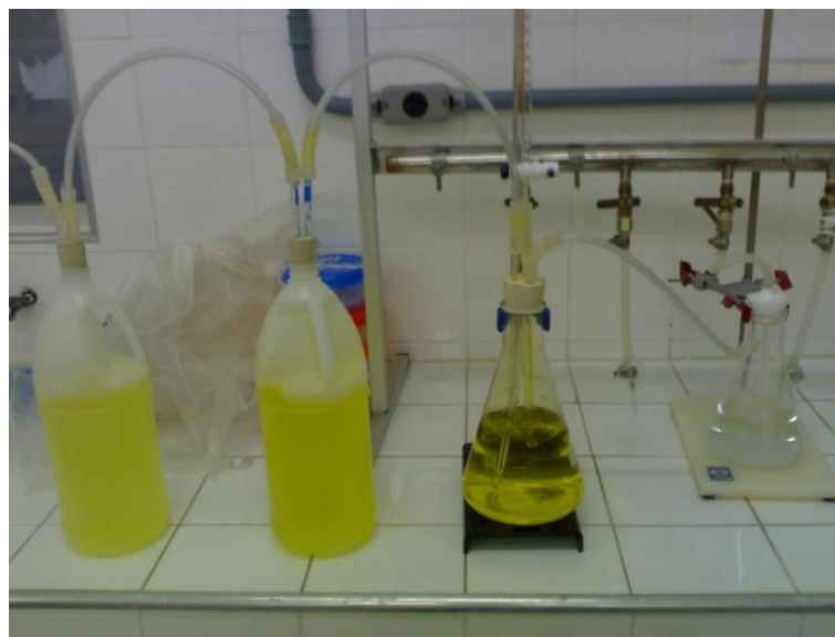
Figura 9: Aparato experimental para geração de dióxido de cloro
