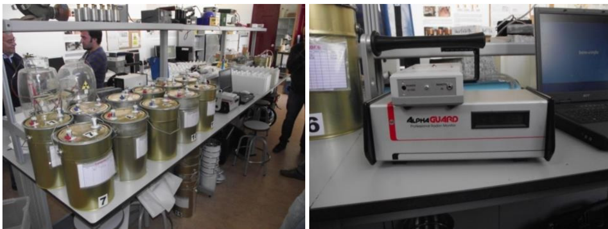
Figura 2.13 – Imagem dos contentores de armazenamento de amostras para a leitura no AlphaGUARD. LRN – Universidade de Coimbra.
