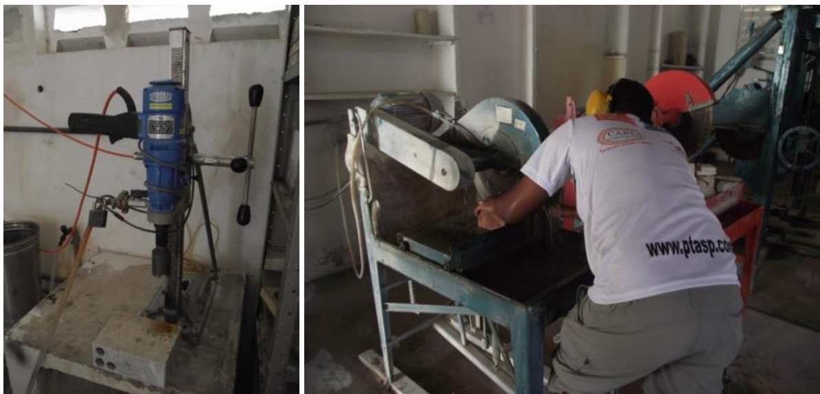
Figura 2.1 – Equipamentos utilizados para a confecção dos corpos de prova nos ensaios de caracterização.
