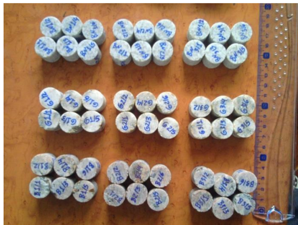
Figura 2.11 – Corpos de prova para o ensaio de porosidade por intrusão de mercúrio.
