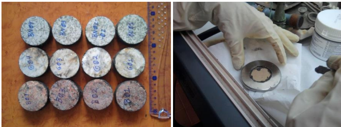
Figura 2.9 – Amostras de rochas utilizadas no permeametro GP-M100A da PMI, no Laboratório da CEPGIST.
