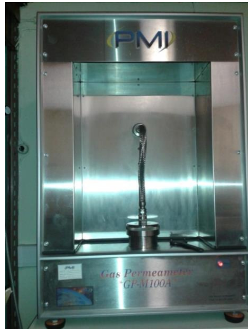
Figura 2.8 – Imagem o permeametro a gás GP-M100A da PMI, no Laboratório da CEPGIST – IST Lisboa – Portugal.
