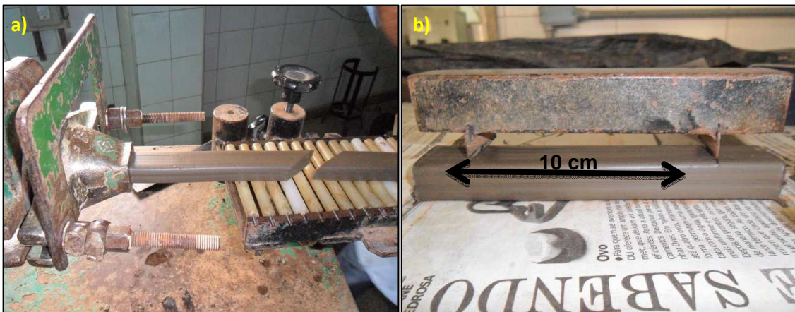
Figura 14 – Preparação do corpo de prova para realização dos ensaios físicos. a) Extrusão e corte; b) marcação do corpo de prova para análise de retração linear.
