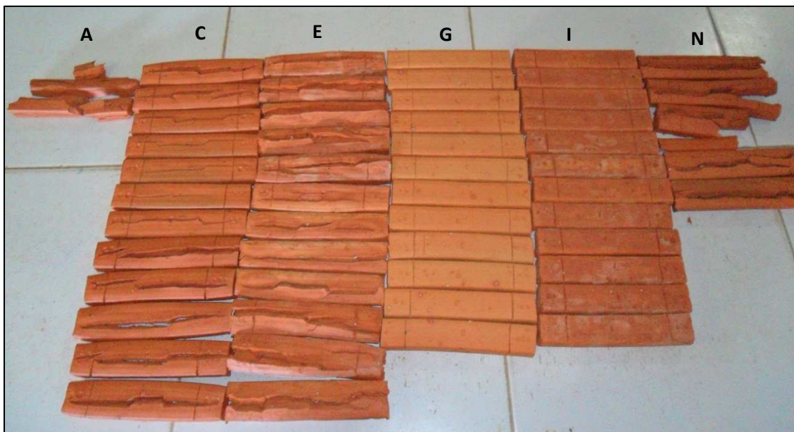
Figura 29 – Presença de trincas nos corpos de prova das amostras “gordas” após a queima. Não foi possível recolher os corpos de prova da amostra L após a queima
