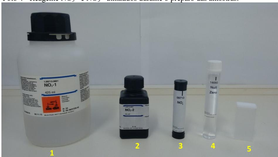
Fonte: o autor (2016). 1 - Reagente  $\text{NO}_3^{-1}$ ; 2 - Reagente  $\text{NO}_3^{-2}$ ; 3 - auto seletor para nitrato (utilizado para selecionar a função de leitura para nitrato no fotômetro Nova 60); 4 - Água destilada (utilizada para configurar e ajustar o valor zero do fotômetro Nova 60); 5 - Cubeta de quartzo de 20 mL.
