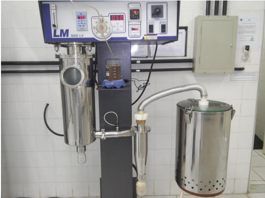
Figura 5: Secagem por atomização ( spray drying ) do isolado proteico de Amburana cearensis produzido. Velocidade de 0,5 L por hora, fluxo de ar 4, temperatura de entrada de 160 °C e temperatura de saída de 100 °C
