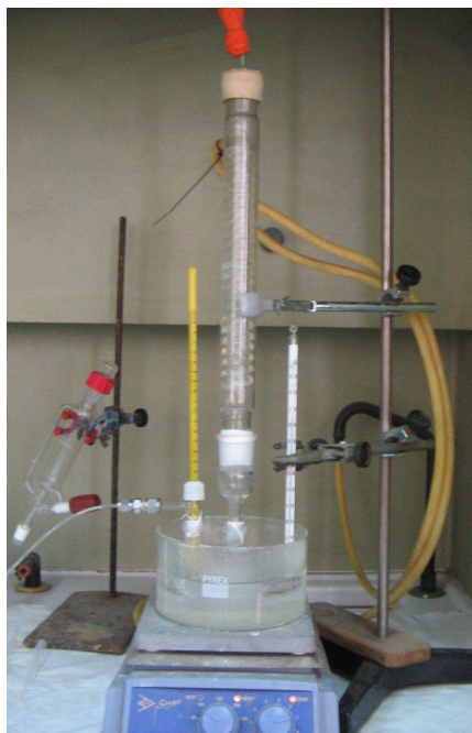
Figura 6.1: Ilustração do reator catalítico utilizado nas reações de transesterificação.
