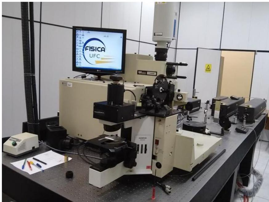
Figura 9 - Espectrômetro, CCD e microscópio utilizado nos experimentos de espectroscopia Raman à temperatura ambiente.
