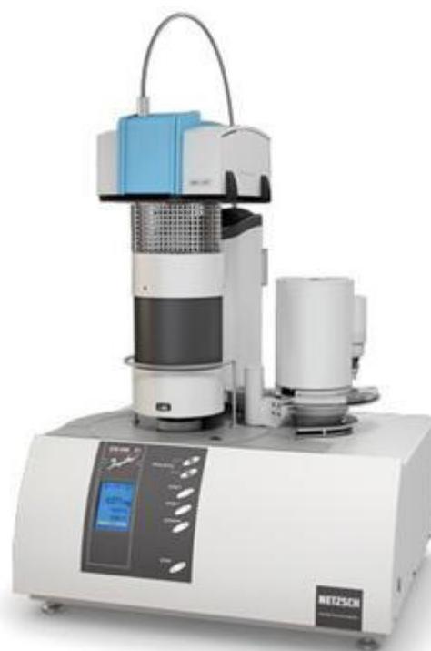
Figura 6 - Analisador térmico simultâneo - Netzsch STA 449 F3 utilizado nos experimentos de análise termogravimétrica (TG).
