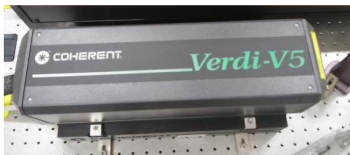
Figura 8 - Fonte emissora de laser de comprimento de onda 532 nm.
