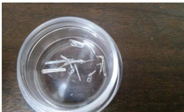
Figura 5- Cristais de ácido DL-glutâmico monohidratado obtidos.
