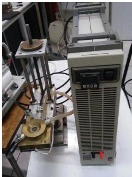
Figura 12- Equipamentos utilizados nos experimentos de espectroscopia Raman sob altas temperaturas.
