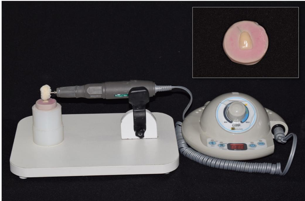
**Figura 1.** Equipamento utilizado para realizar o polimento mecânico nos dentes artificiais em resina acrílica. Dispositivo de silicone para fixação dos dentes artificiais.
