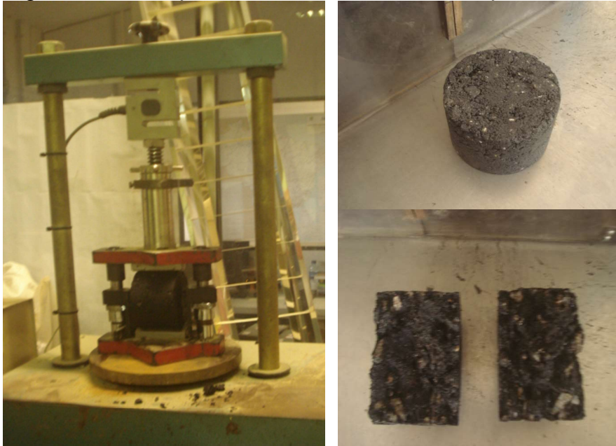
Figura 20– Realização do Ensaio de Resistência à Tração
