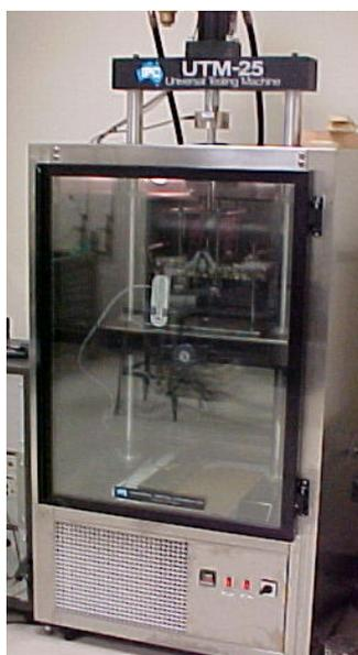
**Figura 21:** Prensa hidráulica UTM-25 utilizada nos ensaios
