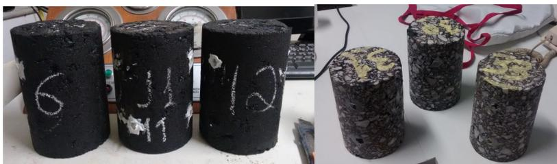
**Figura 19:** CPs das misturas 1 e 4, preparadas para o ensaio de módulo dinâmico
