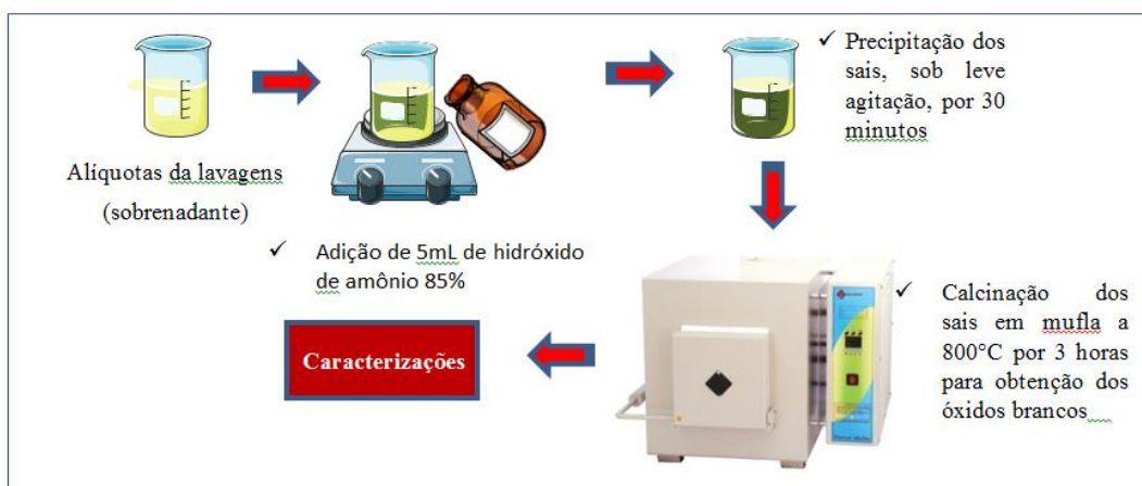
Figura 12 - Esquema de obtenção dos óxidos brancos
