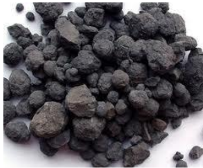
Figura 7 - Amostra de escória de conversor a oxigênio tratada pelo processo BSSF
