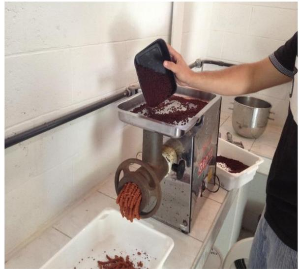
Figura 39 - Preparação das rações ofertadas aos reprodutores, mostrando a forma granulada inicial, a mistura a um agente aglutinante e a formação do pellet pela matriz de 8 mm.
