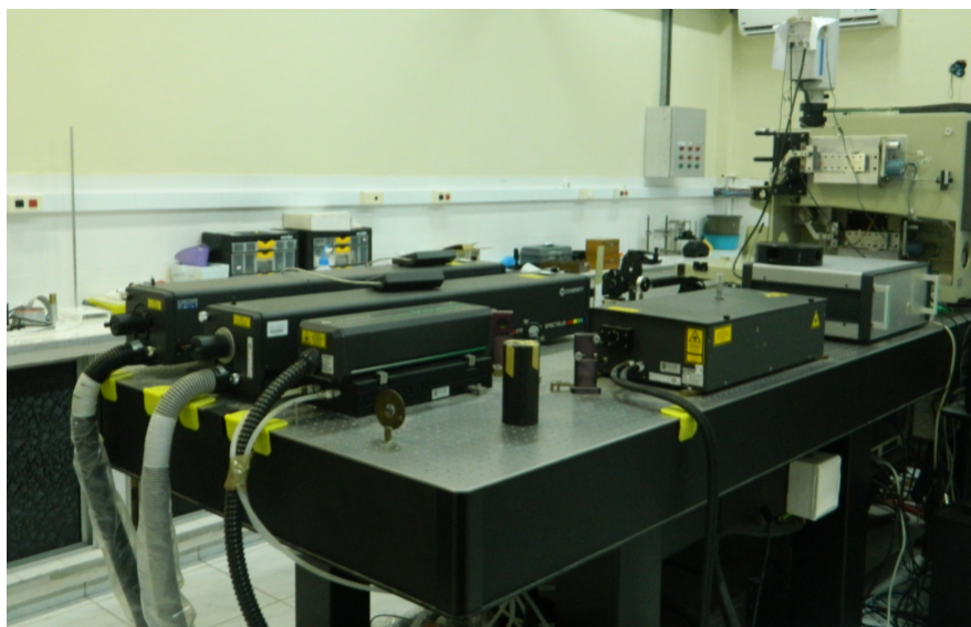
Figura 16: Aparato experimental para a obtenção dos espectros Raman.
