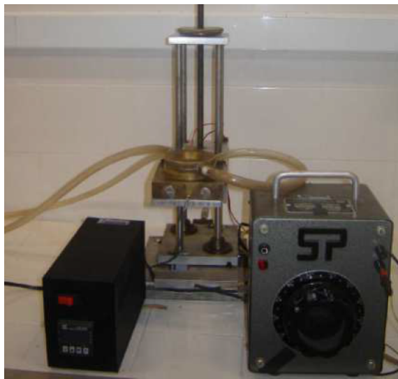
Figura 18: Sistema utilizado nos experimentos de espectroscopia Raman a altas temperaturas.
