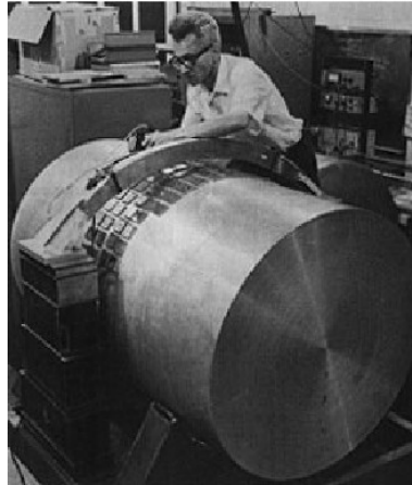
Figura 7: Nessa imagem vemos Joseph Weber configurando seu detector cilíndrico, com modo de ressonância sensível a ondas gravitacionais com frequência próxima a 1660 \text{ Hz} . Esse dispositivo funcionava à temperatura ambiente e utilizava cristais piezoelétricos para transmitir os possíveis sinais de ondas gravitacionais presentes no detector
