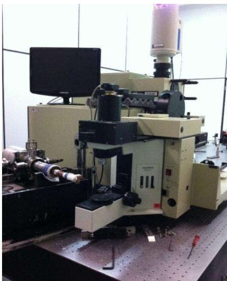
Figura 5: Espectrômetro T 64000 utilizado nos experimentos de espectroscopia Raman.
