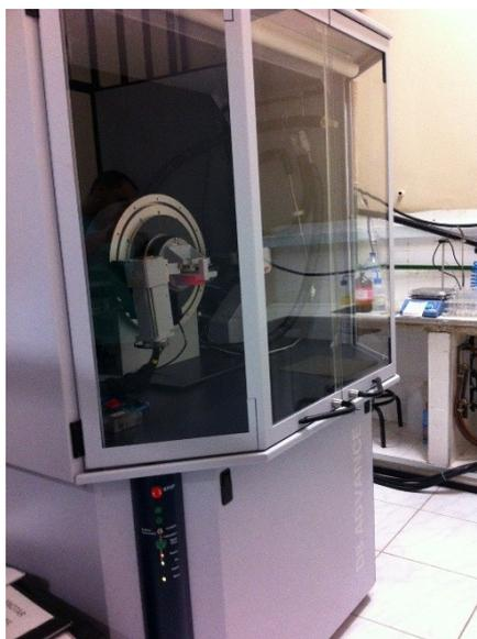
Figura 3: Difratorômetro utilizado para experimentos com as amostras L-lisina.HCl.2H<sub>2</sub>O e DL-lisina.HCl.
