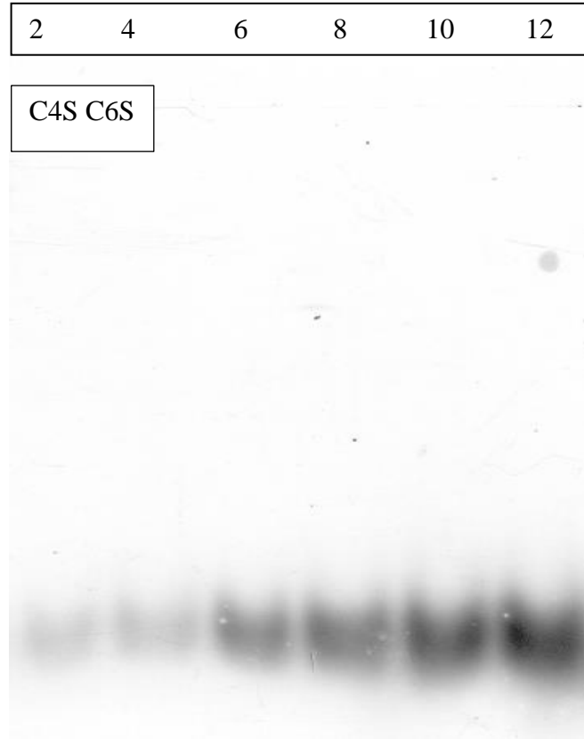
Figura 1 – Curva-padrão de condrotin -6-sulfato (C6S). (A) Eletroforese de diferentes quantidades de C6S em gel de agarose, tampão diaminopropano-acetato 50 mM, pH 9,00 (2-12 µg).
