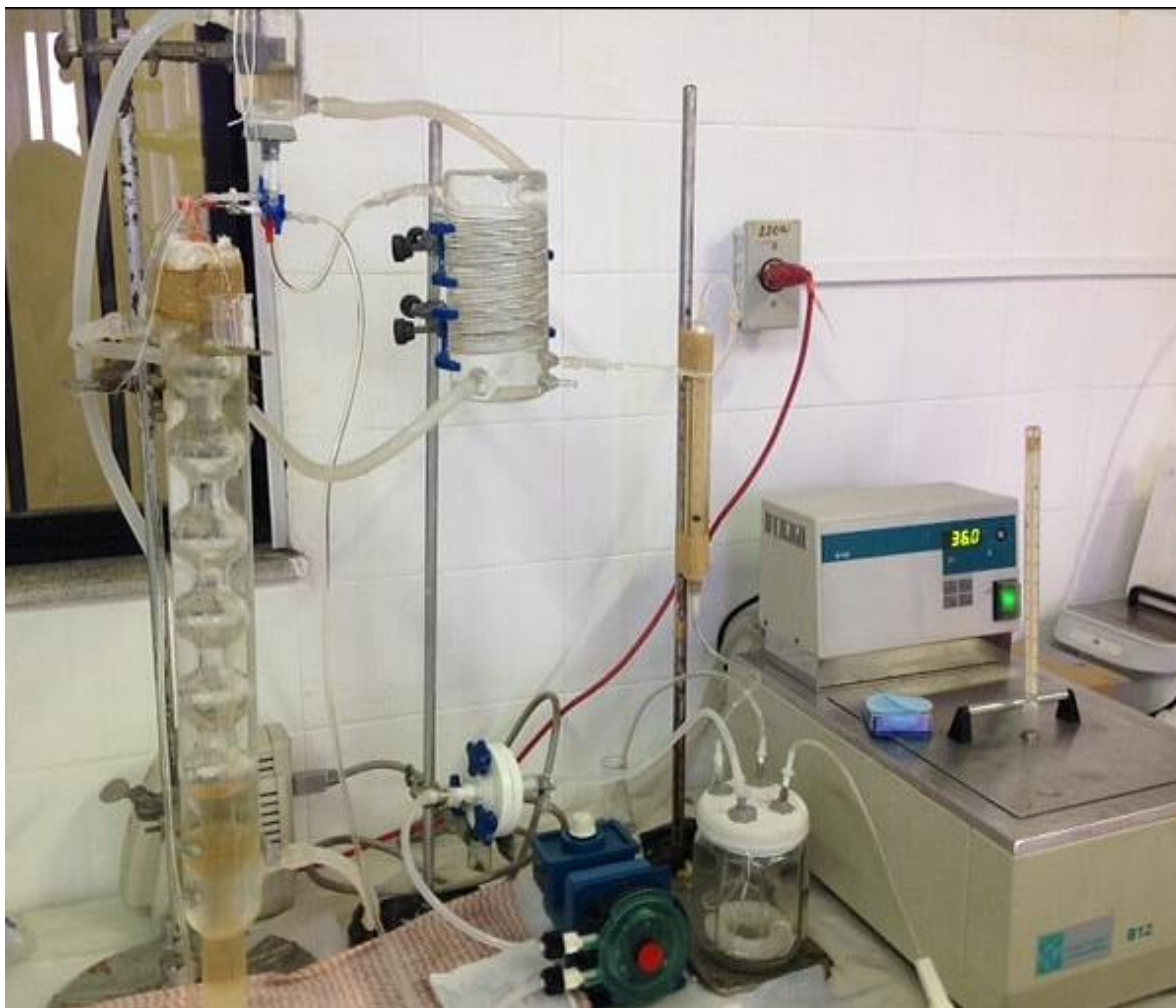
Imagem 2. Sistema de perfusão utilizado nos experimentos(Campos, 1989; Adaptado por Fonteles).
