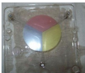
Figura 137 – As películas se encontram num ponto formando ângulos iguais de 120^\circ
