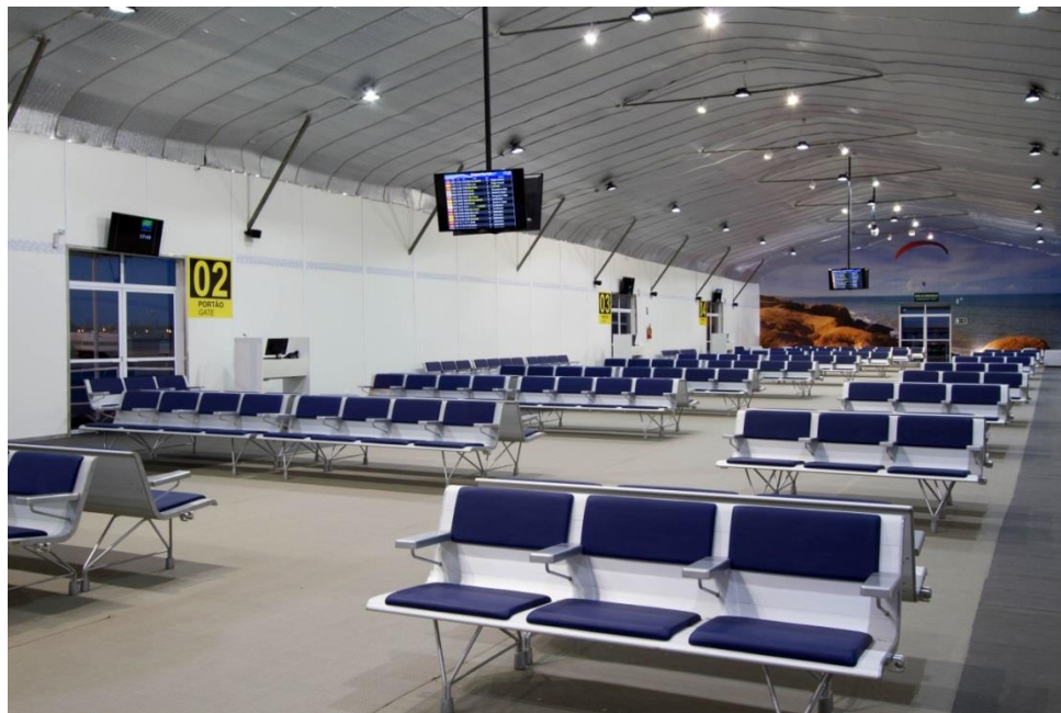
Figura 39 – Estrutura armada como terminal de passageiros no Aeroporto Internacional Pinto Martins em Fortaleza (2014)
