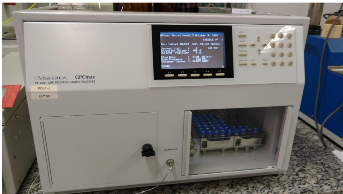
Figura 4 - Cromatógrafo de permeação em gel do laboratório do Núcleo de Pesquisas em Lubrificantes (NPL) da UFC.
