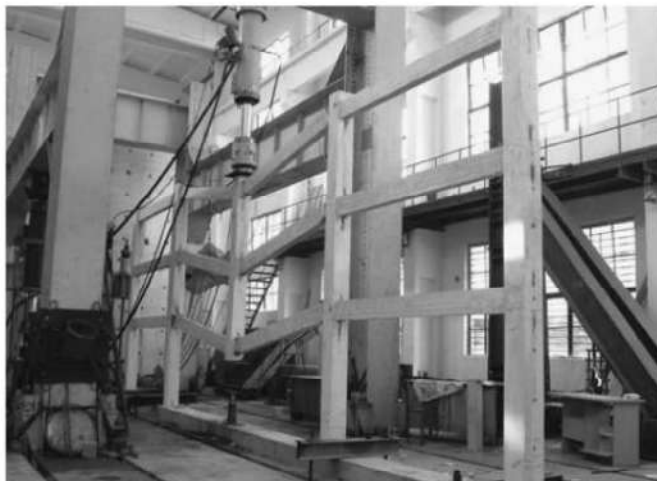
Figura 7 – Ensaio de um pórtico de quatro vãos e três andares
