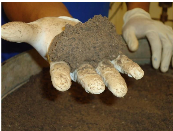
Figura 3.6 – Procedimento manual para definição do teor de emulsão inicial nas misturas solo-emulsão estudadas.
