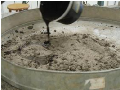
(c) Adição da emulsão asfáltica ao solo.
