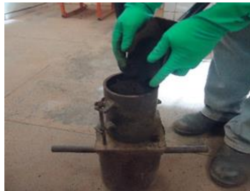
(f) Compactação da mistura solo-emulsão.
