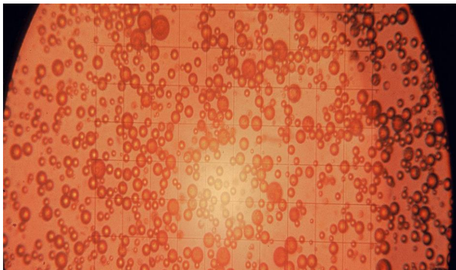
Figura 2.3 – Vista microscópica de uma gota de emulsão asfáltica.
