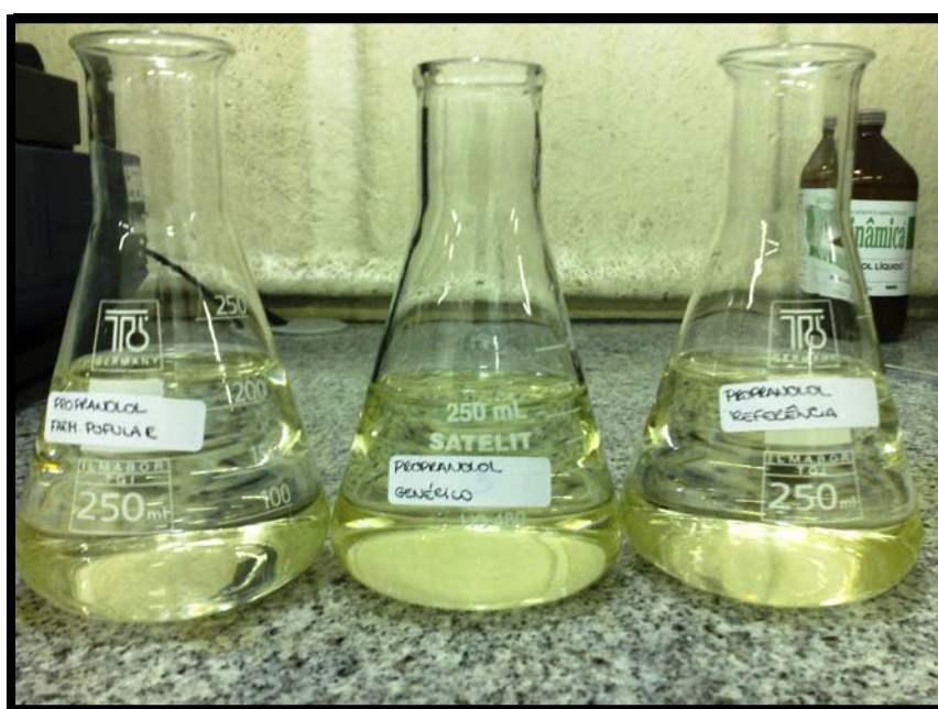
Figura 26 – Soluções contendo comprimidos pulverizados de cloridrato de propranolol acidificadas tratadas com nitrato de prata SR após adição de ligeiro excesso de hidróxido de amônio 6M. O precipitado branco caseoso tornou-se solúvel. Da esquerda para a direita: Farmácia Popular, Genérico e Referência.
