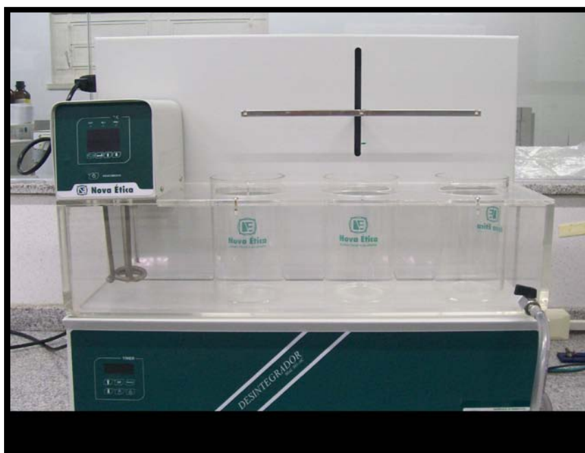
Figura 7 - Aparelho utilizado nos testes de desintegração de comprimidos e cápsulas.
