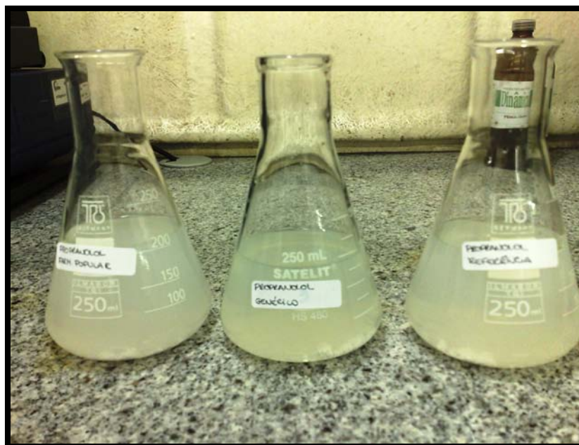
Figura 25 – Soluções contendo comprimidos pulverizados de cloridrato de propranolol acidificadas tratadas com nitrato de prata SR. Formação de precipitado branco caseoso. Da esquerda para a direita: Farmácia Popular, Genérico e Referência.
