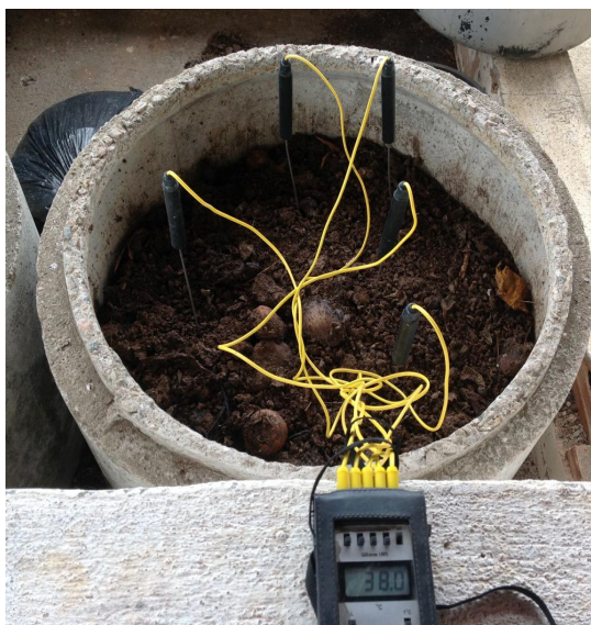
Figura 6: Acompanhamento da temperatura ( ^{\circ}\text{C} ) da pilha de composto orgânico à base de resíduos de produtos hortifrutigranjeiros.
