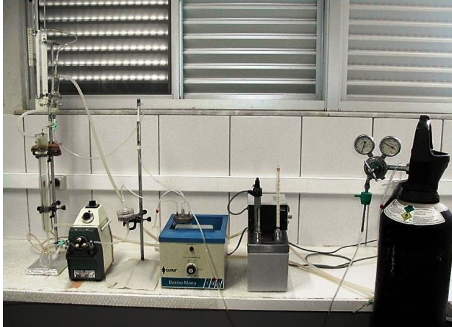
Figura 04: Fotografia representando o sistema de perfusão de rim isolado
