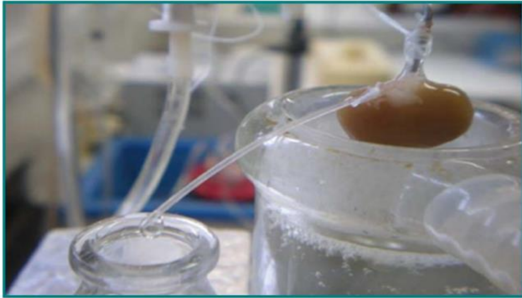
Figura 10 – Rim acoplado ao sistema de perfusão
