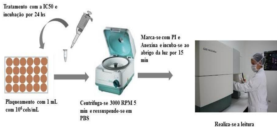
Figura 12 - Desenho esquemático da determinação da integridade da membrana.
