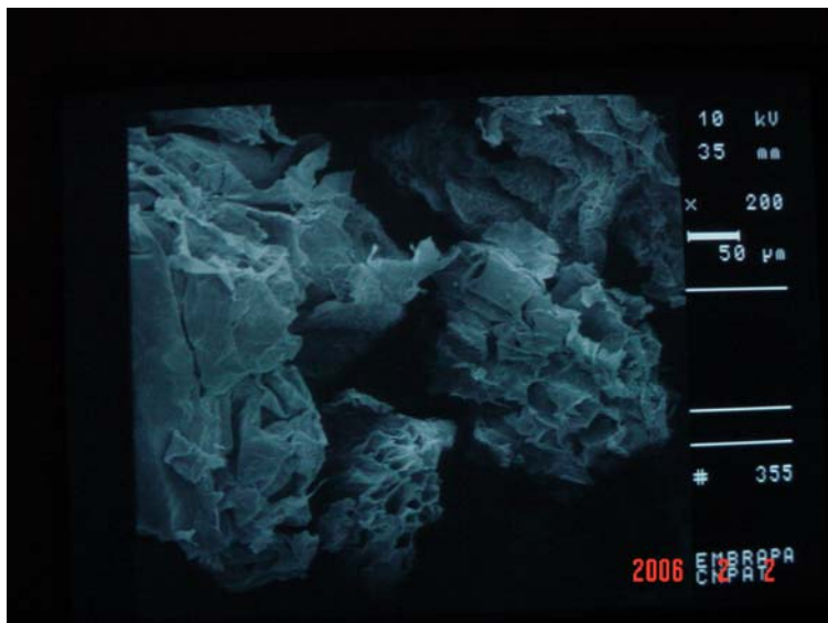
Figura 51. Superfície do material tratado com NaOH 0,1 mol.L -1 de 60-99mesh. Diâmetro dos poros igual a 40-42μm (200X).
