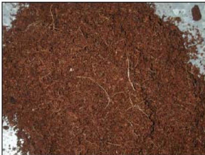
Figura 2. Pó da casca de coco verde obtido após as etapas de trituração, prensa hidráulica, moagem e classificação, lavagem e secagem.
