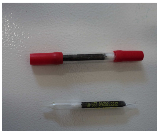
Figura 23. Tubos amostrador ANASORB-CSC (100mg/50mg) utilizado na amostragem de BTEX nos postos de gasolina.
