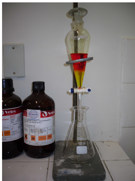
Figura 19. Extração e purificação da solução 2,4-dinitrofenilhidrazina (2,4-DNPH i )
