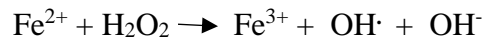
Figura 1.1: Reação de Fenton - Descreve a formação de radicais livres a partir da interação entre o ferro e o peróxido de hidrogênio
