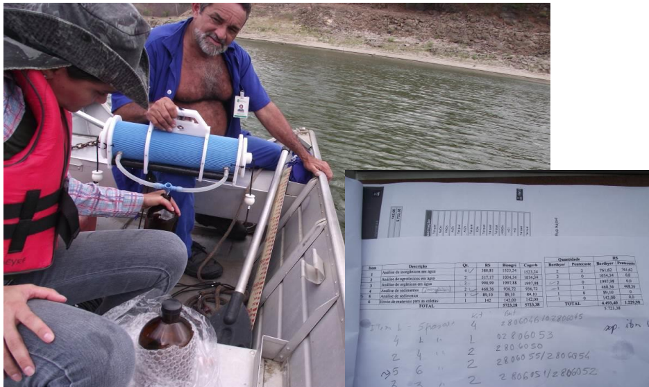
Figura 86-Garrafa de Van Dorn para coletas de água a 0,5 m da superfície e 0,5 m do fundo
