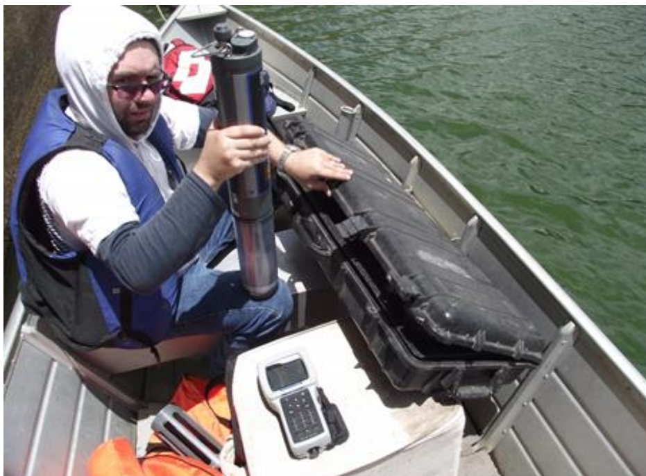
Figura 31-Detalhe do uso da sonda paramétrica na bacia hidráulica do açude Acarape do Meio
