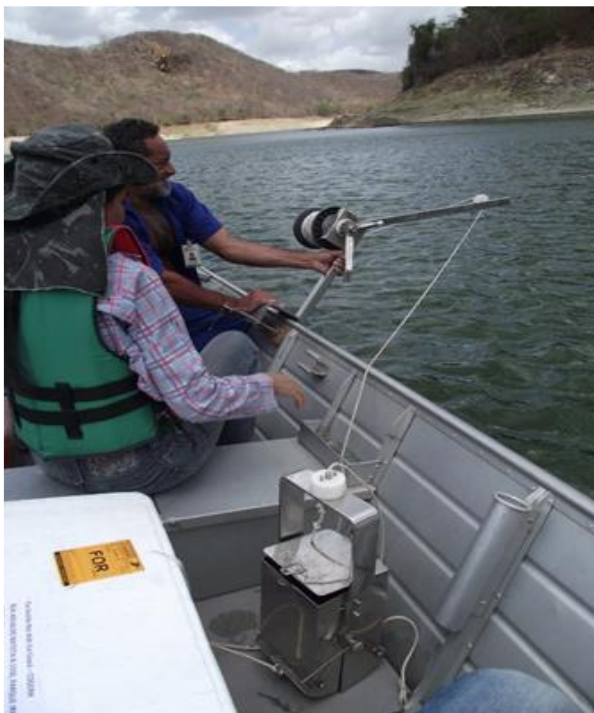
Figura 87-Coleta do sedimento de fundo com a garrafa de Van Veen
