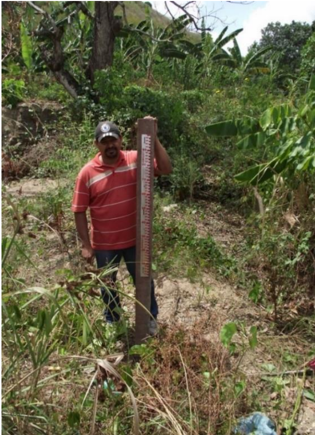
Figura 22-Réguas limnimétricas utilizadas para leituras de lâminas d'água
