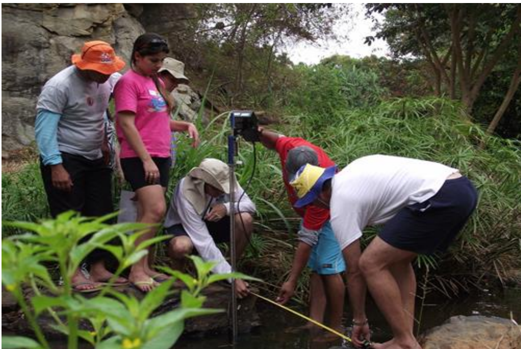
Figura 21-Medição de vazão nas seções utilizando o medidor Flowtracker
