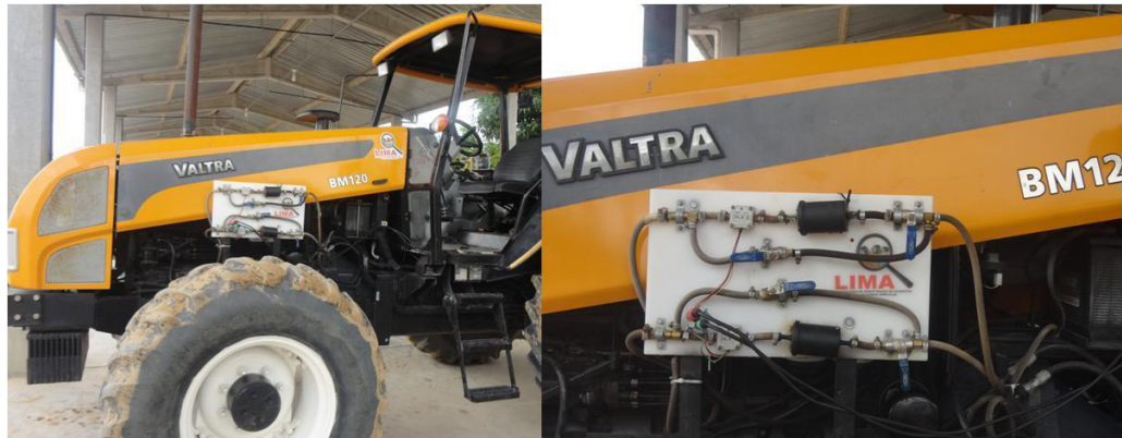
Figura 8 – medidores de fluxo de combustível.
