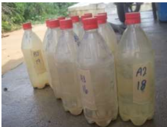
Figura 9. Amostras de escoamento de água por erosão para quantificação da perda de solo.
